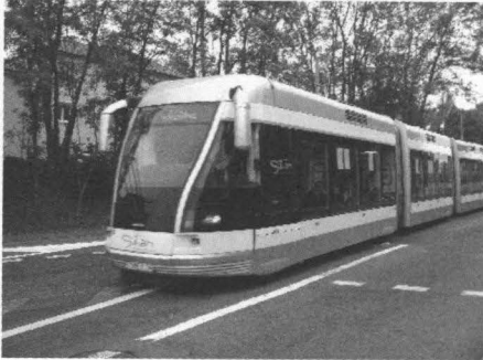
図3 ナンシー市のTVR (道路上をトロリーバスのように走行)
