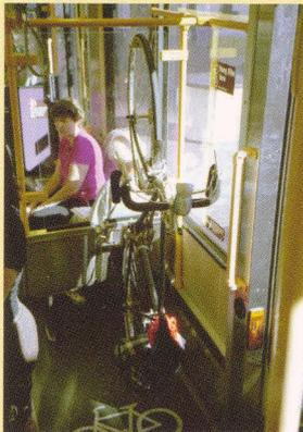
〈ポーランドのLRT・マックス(MAX)の車両にある自転車専用立て〉
