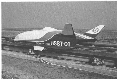
最初の試作機HSST-01号機
