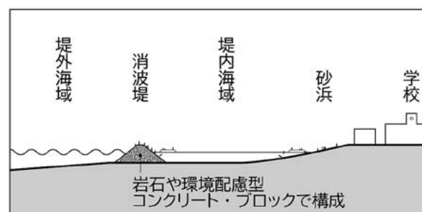
図7 リビング・ブレイクウォーターズの断面模式図
