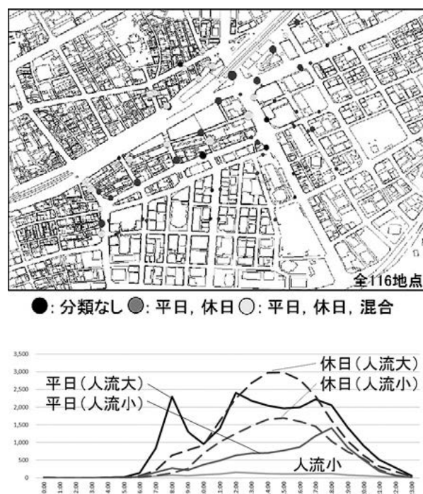
図2 人流データのクラスター分類結果(上)とある測定点でのクラスター分析結果の例(下)
