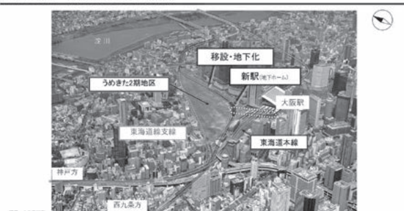
図4 鉄道地下化・新駅設置事業
