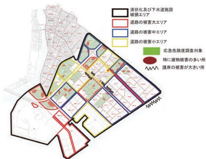
図 8 道路被害の状況 8)
