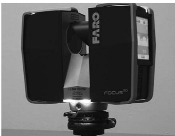
図2 Focus 3D S120レーザ計測器
