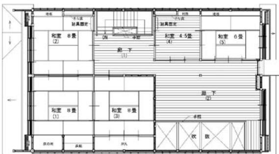
図35 現状変更計画案（2階平面図）
