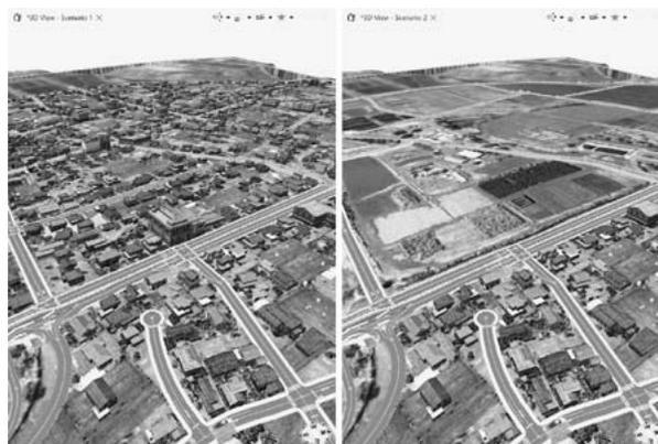
図18 高密度化によるスプロール化の抑制効果を3Dモデルで比較した例（左：高密度化を未実施、右：実施）
