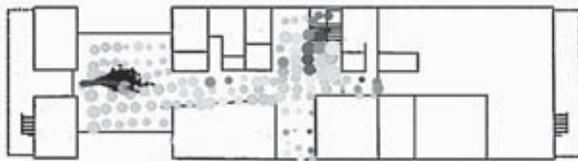
図8：磁気、無線LAN、PDRを用いた測位
