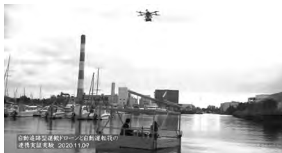
写真1 自動追跡型運搬ドローンと 自動運航筏の連携実証実験 (竹中工務店他) 8) https://www.youtube.com/watch?v=wd5SI7csZZk
