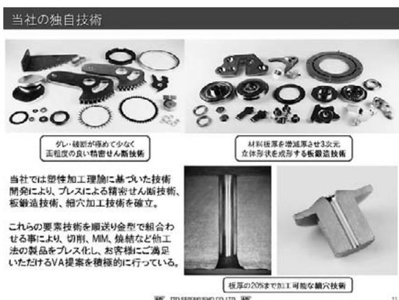
プレス工法は生産性は高いのですが、鑄造、機械加工といった複数工程からの生産品に比べ面粗度が粗いという難点があります。伊藤製作所は順送プレス工法に磨きをかけて、プレス一発で精密成型品を作る金型精度があります。
