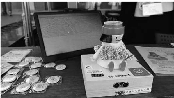
観光地に設置した「いいがね！ボタン」が押された回数をクラウド経由で集計し、ネットのマップ上に表示して、街のおすすめスポットを可視化するデバイス。
