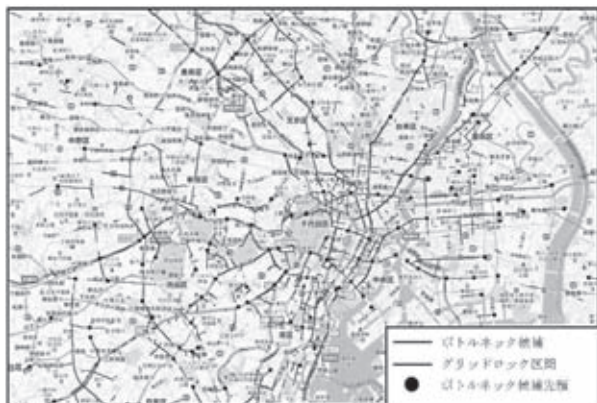
図4-3 東日本大震災時における東京都のグリッドロック区間及びボトルネック候補（芝浦工業大学：東日本大震災時の都区道路のグリッドロック現象に関する基礎的考察より）
